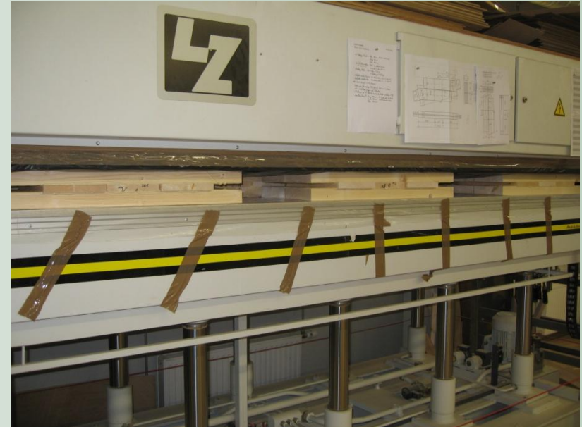
Versuchsanlage und Laborpresse an der TU Graz zur Herstellung von Prüfplatten
