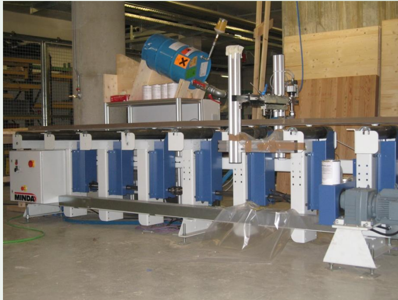
Versuchsanlage und Laborpresse an der TU Graz zur Herstellung von Prüfplatten
